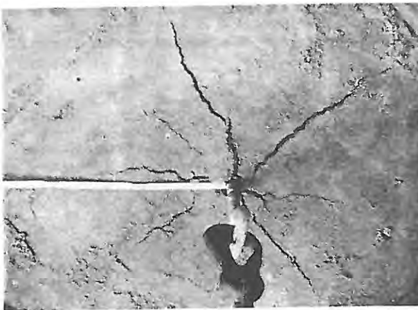
Bild 20: Rissebild eines Erdkeils bei Belastung eines Kreuzankers.
