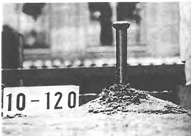
Bild 17: Aufwölbung des Bodens bei Verschiebungen im Sand.
