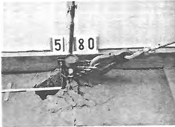
Bild 19: Bildung eines Erdkeils bei Belastung eines Kreuzankers.
