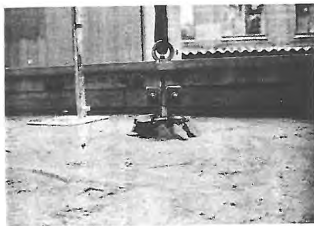
Bild 21: Herausziehen eines Schraubankers unter Mitnahme eines zylindrischen Erdkörpers.
