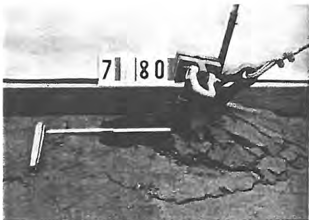
Bild 18: Bild eines Erdkeils bei Belastung eines Flügelankers.
